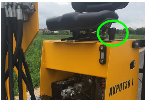
Pour le contrôle de l'huile hydraulique, dévisser la plaque du réservoir d'huile, contrôler visuellement le niveau dans le réservoir.
