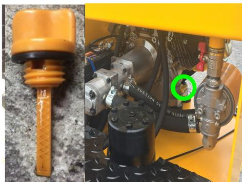
Le niveau d'huile moteur se contrôle de chaque côté du moteur thermique en dévissant et en contrôlant la graduation sur la tirette.
